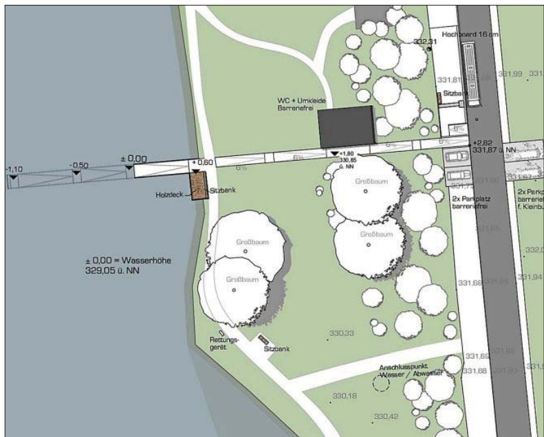
Details der Rampe für Rollstuhlfahrer samt Toilettengebäude.
